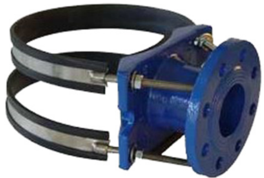
Anbohrarmatur Typ S 2.0 FL mit Flanschabgang bis DN 100 Flanschbohrungen: PN 10 oder PN 16 für Wasserrohre DN 80 - 600
